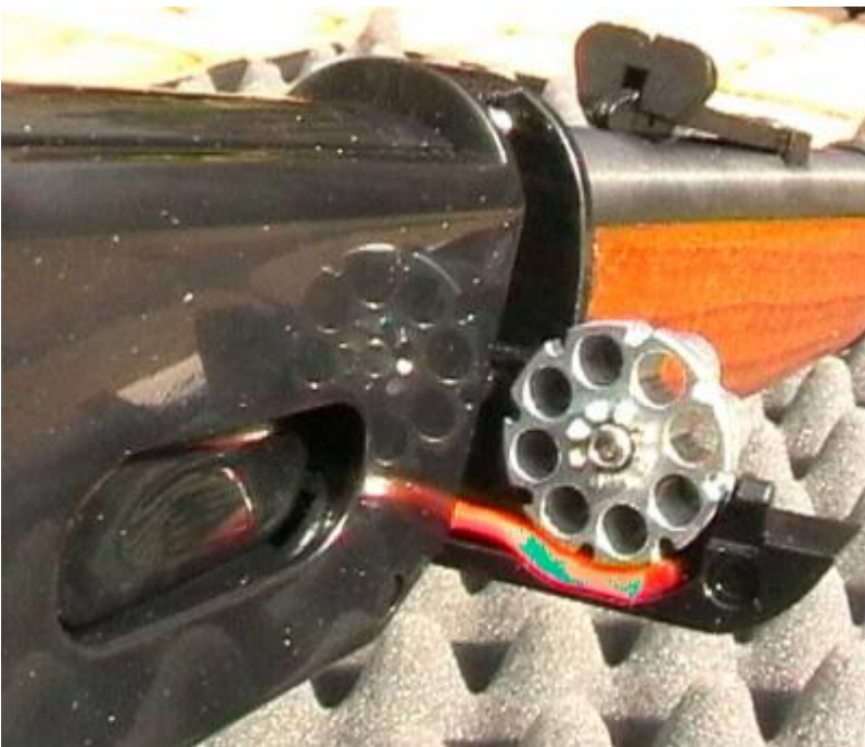
eingedrückte Ladeklappe / Ladebucht mit ausgeklapptem Schwenkarm des WALTHER Lever Action aus dem Testbericht "Walther (Umarex) Lever-Action-Gewehr" von Gunimo
