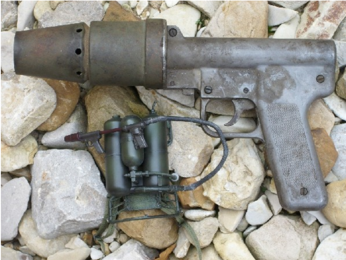
Das Foto oben zeigt den originalen Pistolengriff mit dem Abzugssystem zum Auslösen des Flammstrahls vom amerikanischen Flammenwerfer M2 aus WK2-Fertigung, darunter ein verkleinertes Modell dieses Flammenwerfers. Deutlich zu sehen sind hier die beiden großen Flammöltanks und in der Mitte der kleine Tank mit dem Treibmittel.
